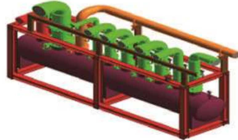
BIM机房管线及设备分段与集成预制加工模型图五
