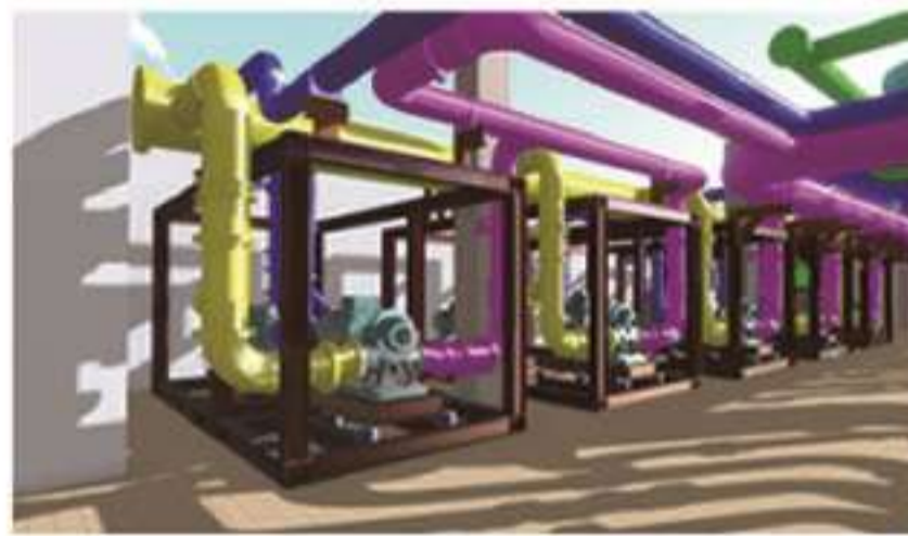
BIM机房管线及设备分段与集成预制加工模型图五
