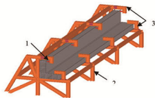
图6 组合型钢箱形钢板剪力墙实体矫正示意图
